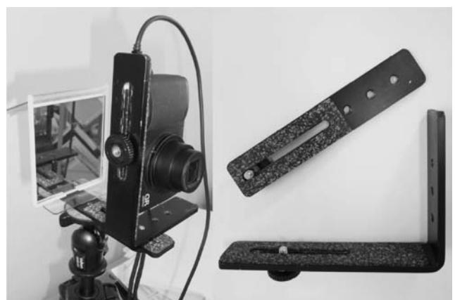
写真1 ブラケットによるカメラの固定
